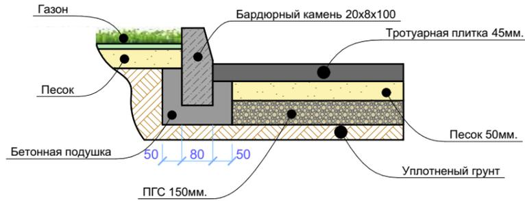
**Схема устройства примыкания тротуарной плитки к проезду**
